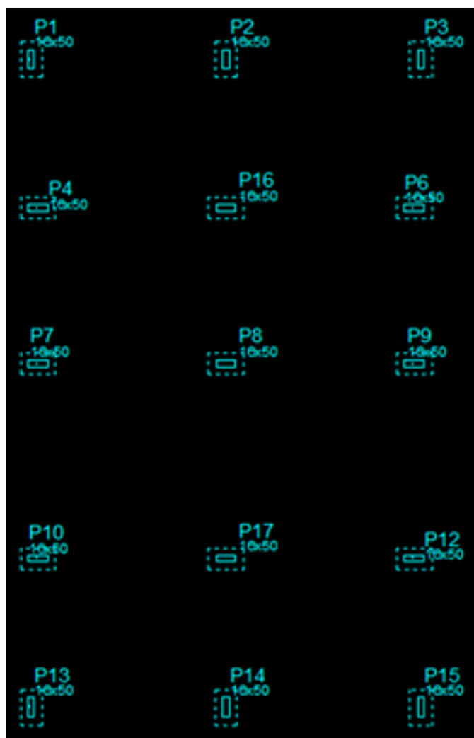
Figura 13 – Lançamento do pavimento “ Térreo ” sem vigas
