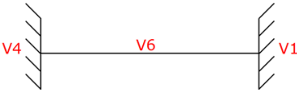
Figura 8 – Modelo estrutural da viga V6 considerando-a bi-engastada
