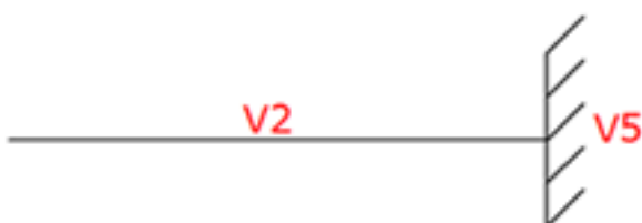
Figura 3 – Modelo estrutural da viga V2
