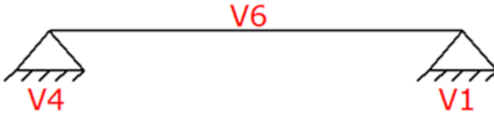
Figura 11 – Modelo estrutural da viga V6 considerando-a bi-apoiada
